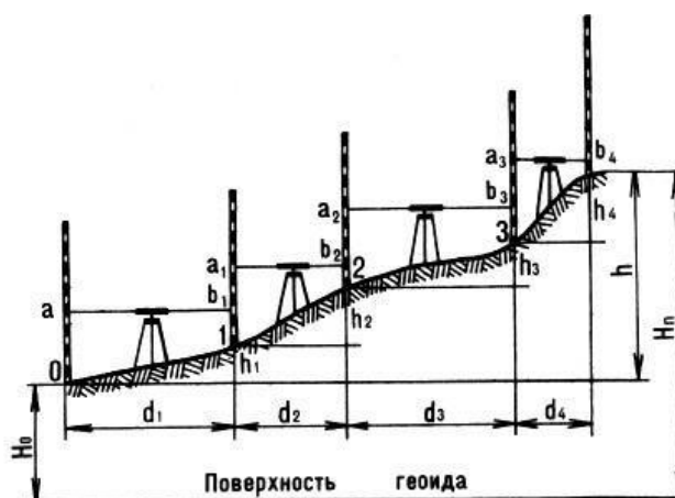
Рис. 17. Схема последовательного нивелирования.
